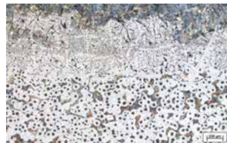
Schliffbild eines GJS 400-15 mit entartetem Randgefüge.
