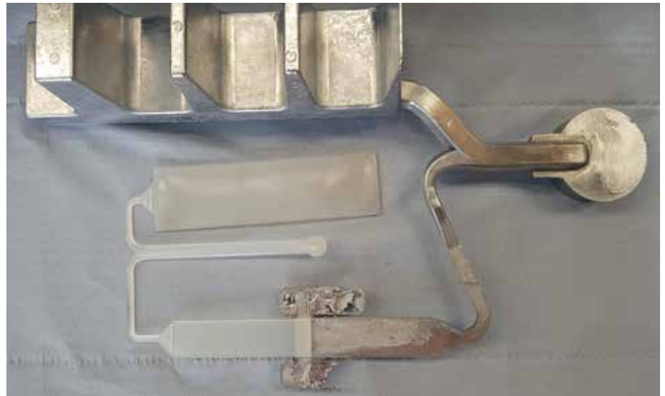
Aluminium-Kunststoff-Hybridbauteil, hergestellt mit dem neuen Hybrid-III-Werkzeug.
