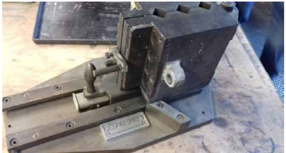
Optimiertes beheizbares Werkzeug zur Herstellung von Formstoff-Biegeriegeln.
