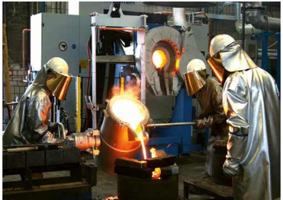
Abguss einer 1500 °C heißen Gusseisenschmelze.
