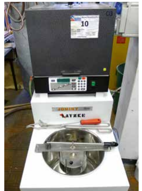
Installation des Jominy-End-Quench-Testgeräts.
