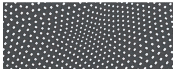
REM-Aufnahme von gerichtet erstarrter NiAl-9Mo (at.%) Legierung mittels Bridgman-Verfahren, Schliff längs zur Faserrichtung. Die Aufnahmen wurden am IMM durchgeführt.
