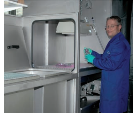
Bild: Rissprüfung mittels neuer fluoreszierender Farbeindringprüfung
