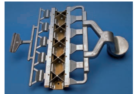
Abb. 1: Druckgegossenes Prinzip-Bauteil mit Stahlblecheinleger
