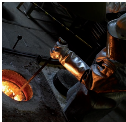
Gusseisenpraktikum: Abschlacken einer Schmelze.
