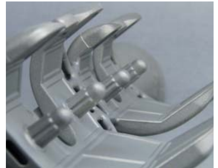
Im Feinguss gefertigtes Knieimplantat aus einer Titan-Legierung
