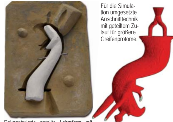
Rekonstruierte geteilte Lehmform mit Kern zum Guss eines kleineren Greifenprotomen.
