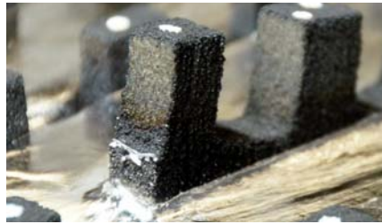
Sichtbarer Verzug durch Hitzeeinwirkung einer Aluminiumschmelze nach Abschluss der Messung.
